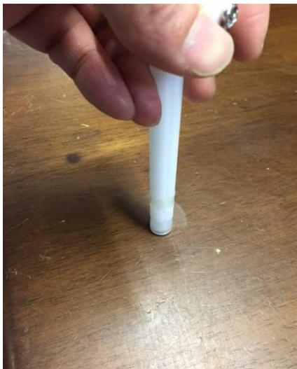
\* 網にほこりなどが溜まって、流量が落ちた場合、ノズルキャップを分解して網を洗う必要がありますが、元に戻す際、ノズルとノズルキャップで網をしっかりとさむよう、机などで完全に押し込んで下さい。
