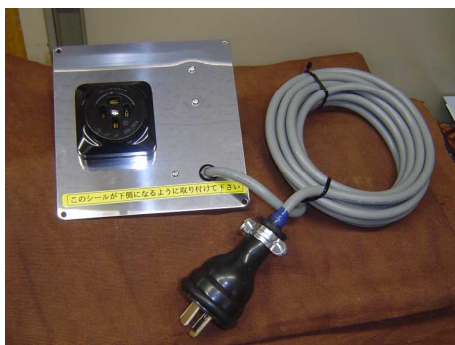
⑤ポンプON/OFF配電盤 待ちタンクが満杯になったら、送液ポンプを止めます
