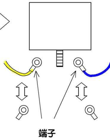
③ 電気をいれてブロックを垂直にして電磁弁が開いた音を確認。端子同士を触れあわせて電磁弁の音が止まるのを確認
