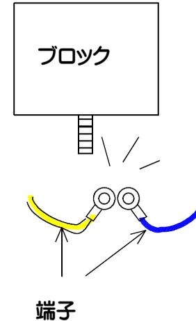
④ 端子をブロックに留めてノズルをセットしてナットを締めてネジの頭同士が接触していることを確認
