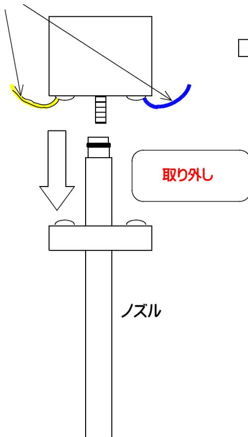
② ネジを取って端子を出し端子部分を切って新しい端子に取り替える
